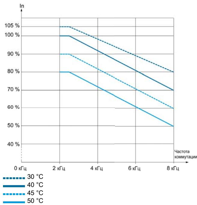
Преобразователи частоты для напольного монтажа — все типоразмеры — 380–440 В — тяжелый режим
