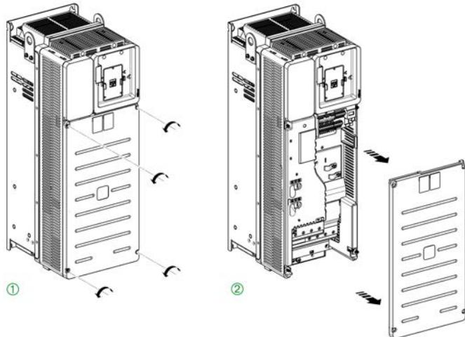
Для доступа к клеммам на преобразователях частоты **типоразмеров 4 и 5** необходимо руководствоваться следующими инструкциями.
