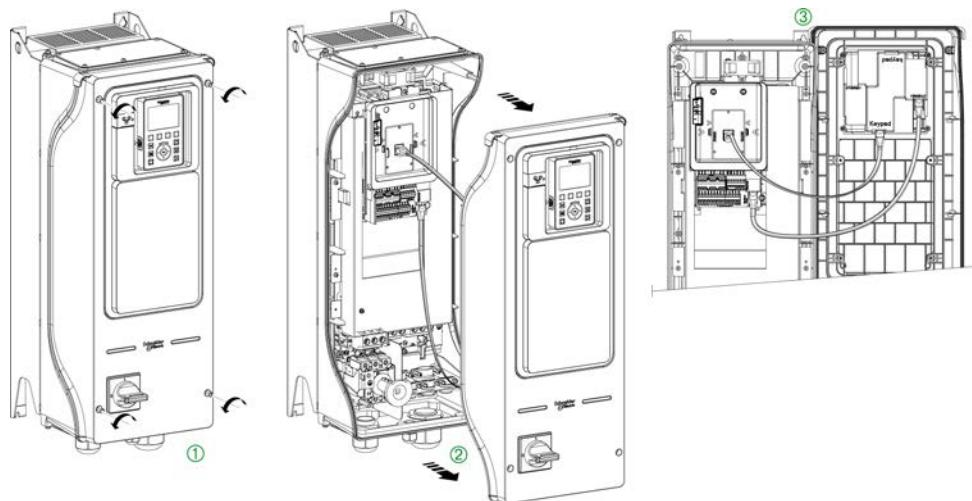
**Доступ к клеммам на преобразователях частоты типоразмеров В и С**
