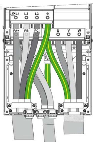
Клеммы РА/+ и РВ используются для подключения тормозного резистора. См. инструкцию к тормозным резисторам [NHA87388](#) на сайте [www.schneider-electric.com](http://www.schneider-electric.com).
