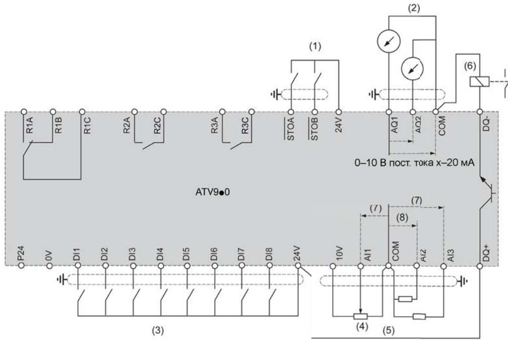
(1) STO (функция безопасного отключения крутящего момента), (2) аналоговый выход, (3) цифровой вход — инструкции по экранированию приведены в разделе «Электромагнитная совместимость» ([см. стр. 179](#)), (4) эталонный потенциометр (например, SZ1RV1002), (5) аналоговый вход, (6) цифровой выход, (7) 0–10 В пост. тока, x-20 мА, (8) 0–10 В пост. тока, -10...+10 В пост. тока.
