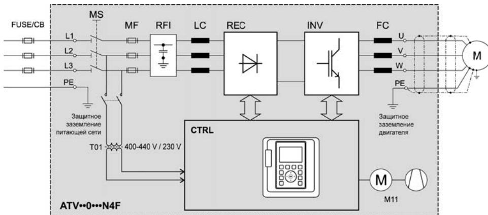
**ATV...N4F** Преобразователь частоты Altivar Process для напольного монтажа
