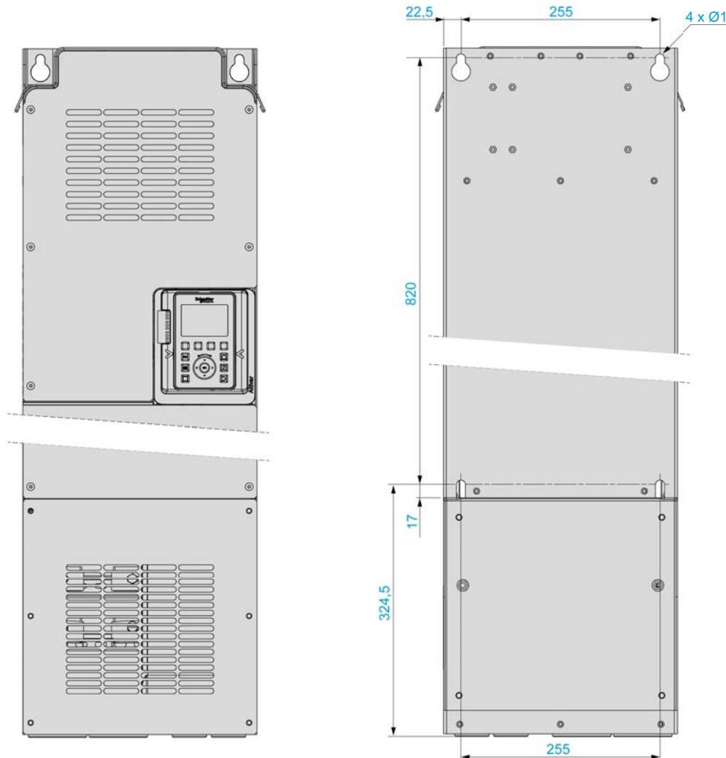
**ПРИМЕЧАНИЕ.** Нижняя часть с соединительной коробкой [VW3A9704](#) приобретается отдельно. Она обеспечивает возможность монтажа устройства на стену. Она обеспечивает степень защиты IP21 в нижней части, а также соответствие типу 1 по UL.
