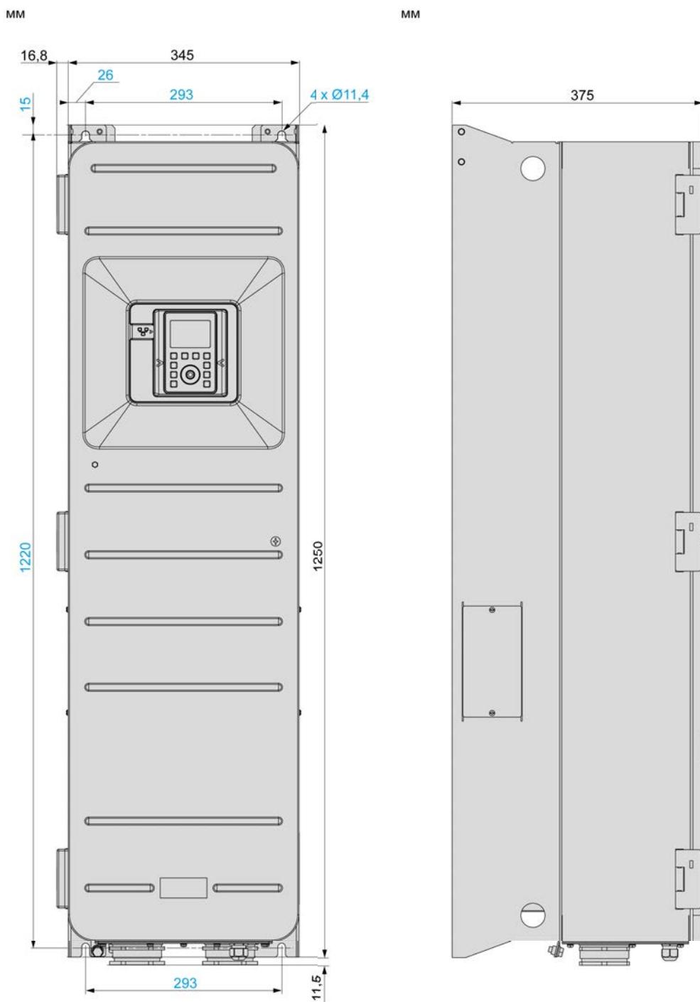
Преобразователи частоты со степенью защиты IP55 / соответствующие типу 1 по UL с вводным выключателем — вид спереди и сбоку
