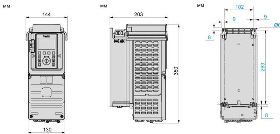
Преобразователи частоты со степенью защиты IP20 — вид спереди, сбоку и сзади
