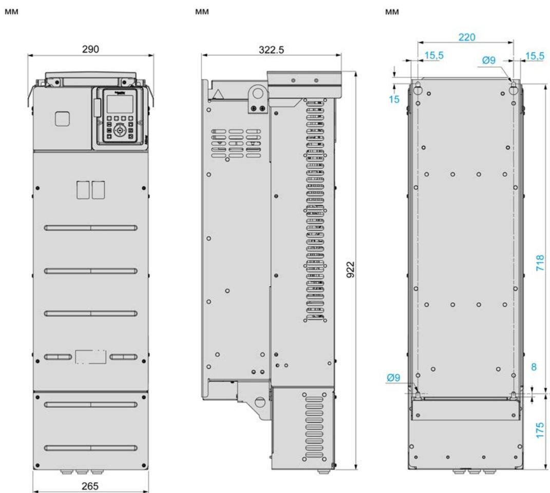
Преобразователи частоты со степенью защиты IP20, кроме нижней части (IP00), — вид спереди, сбоку и сзади
