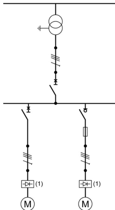
(1) Преобразователь частоты
