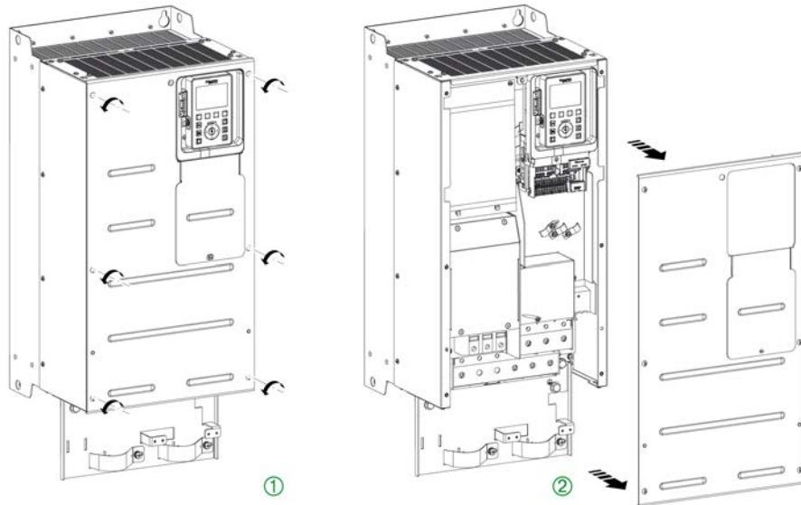
Для доступа к клеммам на преобразователях частоты **типоразмеров 3Y и 5Y** необходимо руководствоваться следующими инструкциями.
