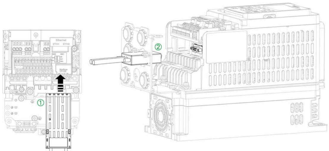
Для обеспечения правильного подключения управляющей части при установке и подключении модуля полевой шины PROFIBUS на преобразователях частоты типоразмера 1 необходимо руководствоваться следующими инструкциями.
