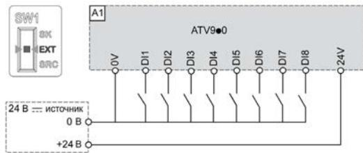
Переключатель установлен в положение **EXT** (внешний приемник) **с функциональной развязкой** цифровых входов. Данная конфигурация требует использования 2 внешних блоков питания.
