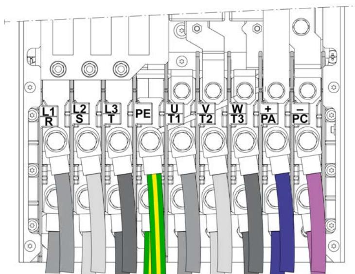
Клеммы PA/+ и PC/- используются для подключения тормозного модуля. См. инструкцию к тормозному модулю [NVE16635](#) на сайте [www.schneider-electric.com](http://www.schneider-electric.com).
