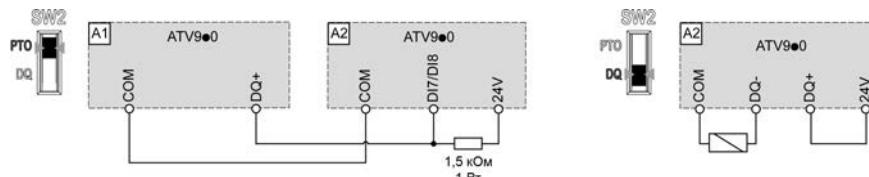
**Переключатель SW1 установлен в положение SRC (режим внешнего источника)**
