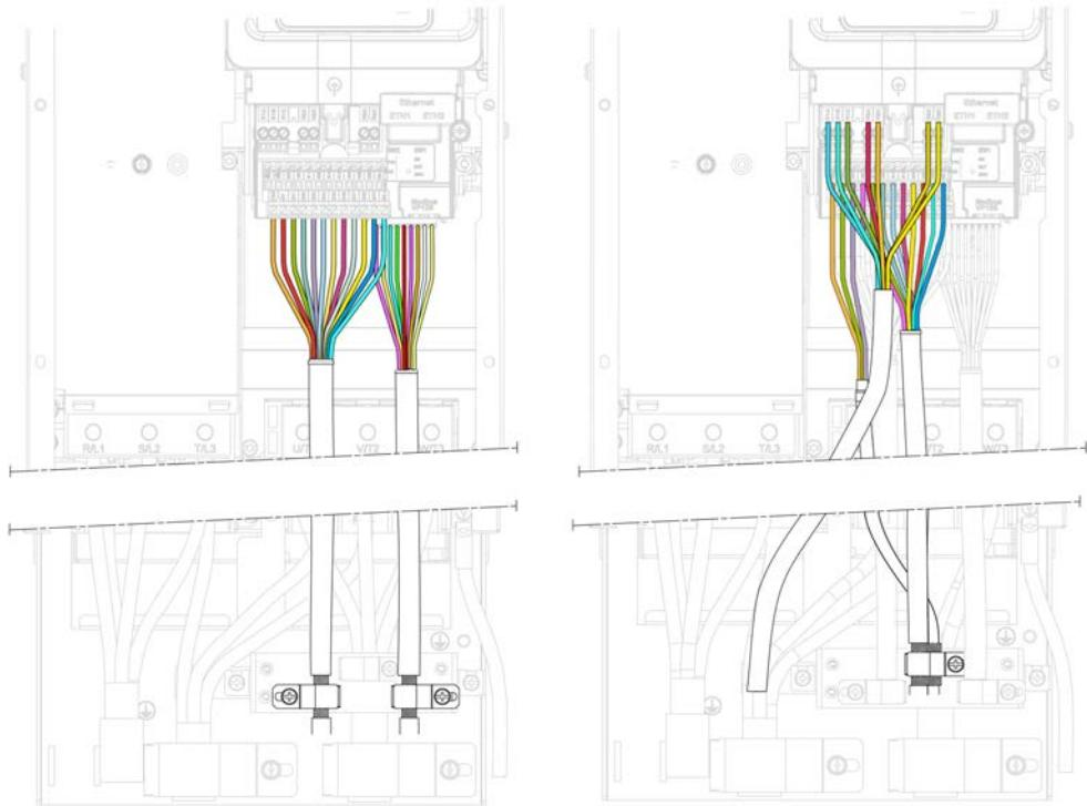
Пример: схема подключения кабелей на преобразователе частоты типоразмера 5Y
