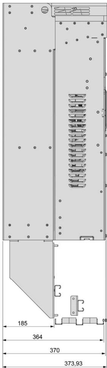
Преобразователи частоты со степенью защиты IP21 в верхней части и IP20 в нижней / соответствующие типу 1 по UL — вид сбоку и спереди
