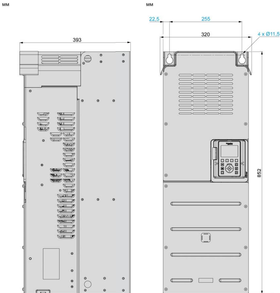
Преобразователи частоты со степенью защиты IP21 / соответствующие типу 1 по UL — вид спереди, сзади и сбоку
