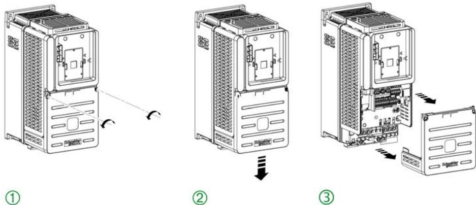
Для доступа к клеммам на преобразователях частоты **типоразмеров 1–3** со степенью защиты IP20 необходимо руководствоваться следующими инструкциями.
