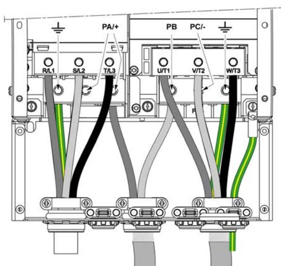
Клеммы PA/+ и PB используются для подключения тормозного резистора. См. инструкцию к тормозным резисторам [NHA87388](#) на сайте [www.schneider-electric.com](http://www.schneider-electric.com).
