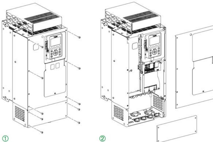
Для доступа к клеммам на преобразователях частоты **типоразмеров 3S и 5S** необходимо руководствоваться следующими инструкциями.
