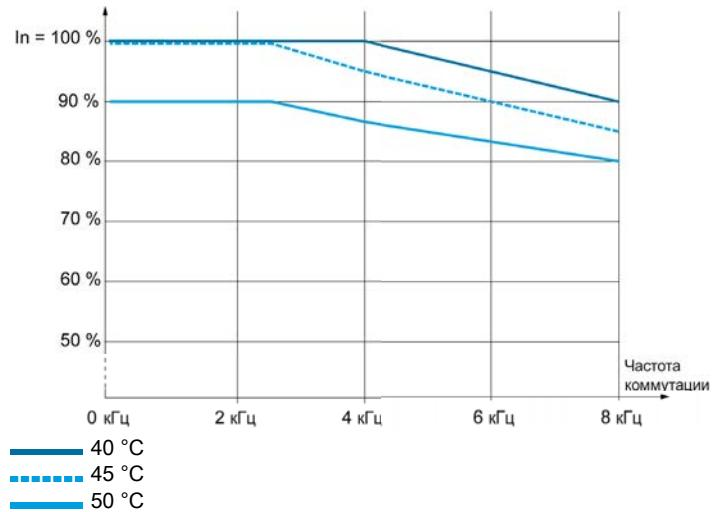
Преобразователи частоты для напольного монтажа — все типоразмеры — 380–440 В — нормальный режим
