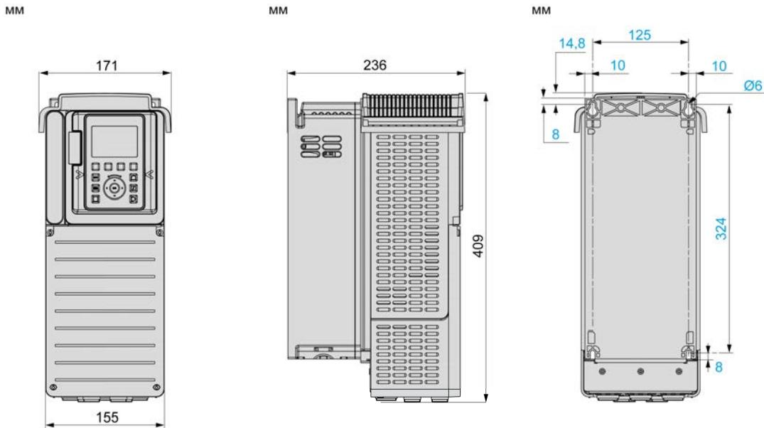
Преобразователи частоты со степенью защиты IP20 — вид спереди, сбоку и сзади
