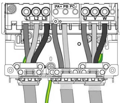
Клеммы PA/+ и PB используются для подключения тормозного резистора. См. инструкцию к тормозным резисторам [NHA87388](#) на сайте [www.schneider-electric.com](http://www.schneider-electric.com).
