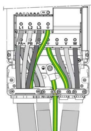
Клеммы PA/+ и PB используются для подключения тормозного резистора. См. инструкцию к тормозным резисторам [NHA87388](http://www.schneider-electric.com) на сайте [www.schneider-electric.com](http://www.schneider-electric.com).
