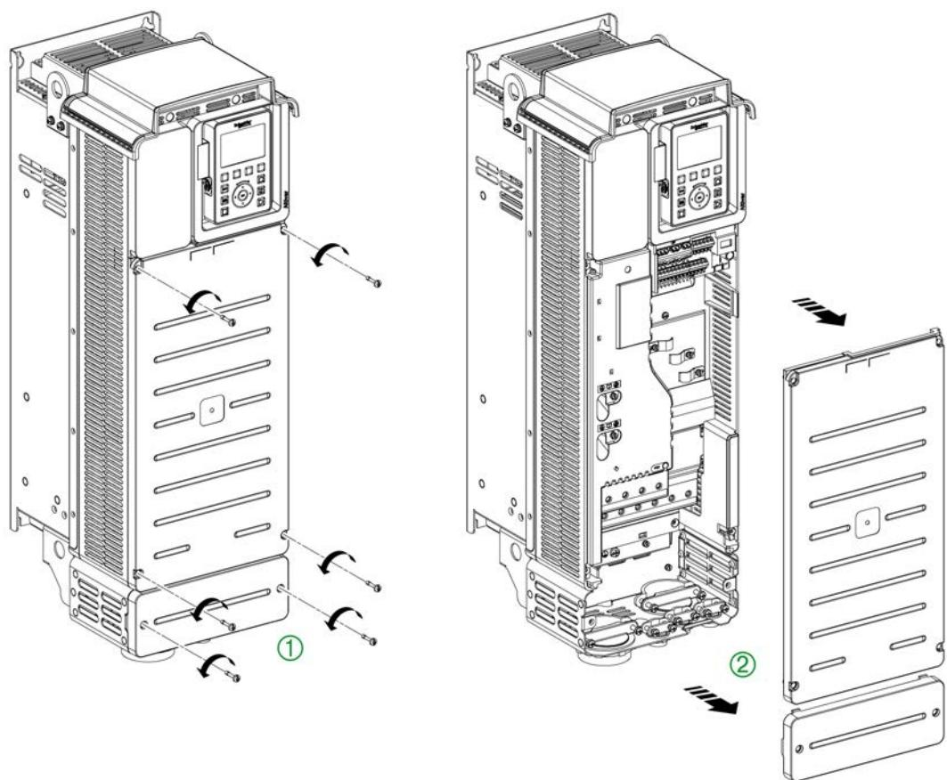
Для доступа к клеммам на преобразователях частоты **типоразмеров 4 и 5** необходимо руководствоваться следующими инструкциями.
