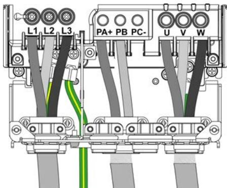
Клеммы PA/+ и PB используются для подключения тормозного резистора. См. инструкцию к тормозным резисторам [NHA87388](#) на сайте [www.schneider-electric.com](http://www.schneider-electric.com).
