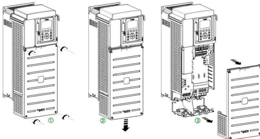
Для доступа к клеммам на преобразователях частоты **типоразмеров 1–3** необходимо руководствоваться следующими инструкциями.
