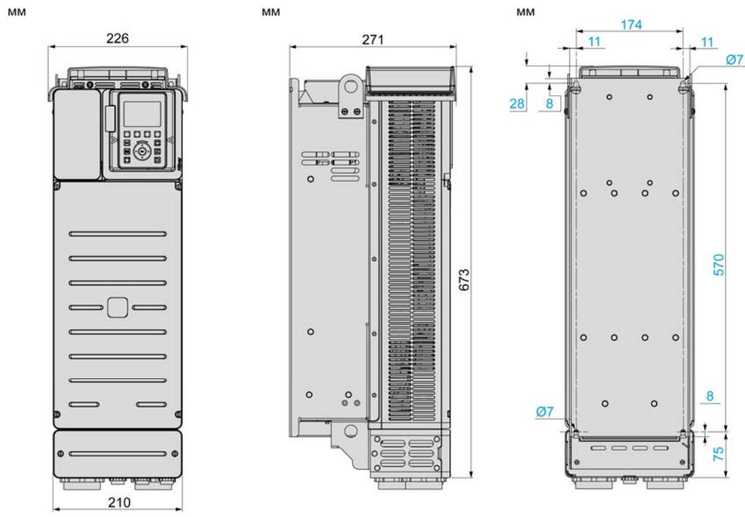
Преобразователи частоты со степенью защиты IP20, кроме нижней части (IP00), — вид спереди, сбоку и сзади
