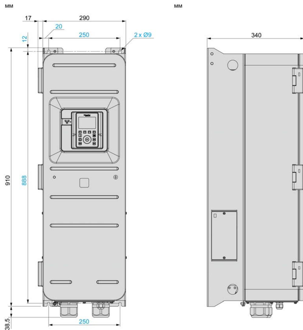
Преобразователи частоты со степенью защиты IP55 / соответствующие типу 1 по UL с вводным выключателем — вид спереди и сбоку
