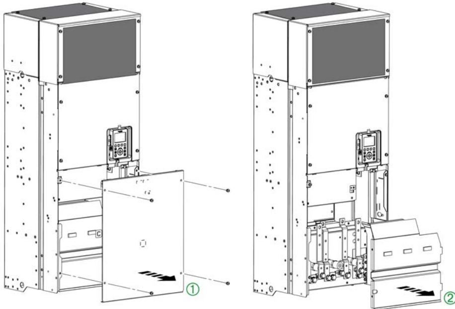
Для доступа к клеммам на преобразователях частоты **типоразмера 7** необходимо руководствоваться следующими инструкциями.
