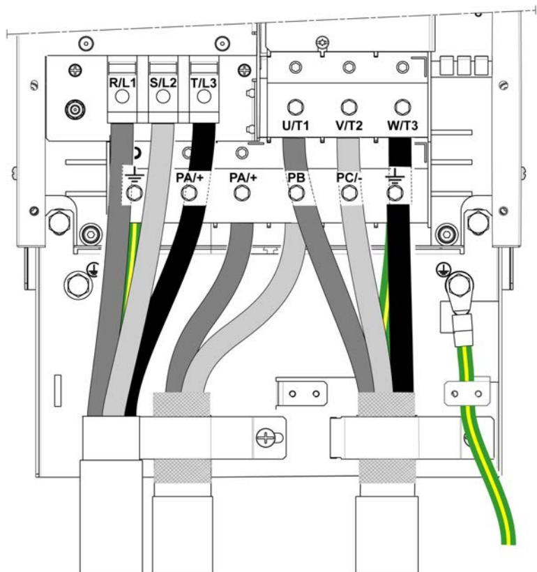
Клеммы PA/+ и PB используются для подключения тормозного резистора. См. инструкцию к тормозным резисторам [NHA87388](#) на сайте [www.schneider-electric.com](http://www.schneider-electric.com).
