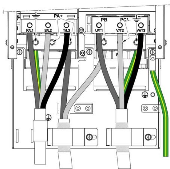
Клеммы PA/+ и PB используются для подключения тормозного резистора. См. инструкцию к тормозным резисторам [NHA87388](http://www.schneider-electric.com) на сайте [www.schneider-electric.com](http://www.schneider-electric.com).
