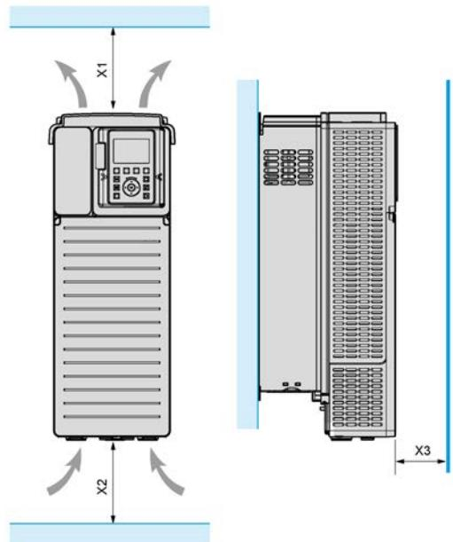
Минимальный зазор в зависимости от типоразмера устройства
