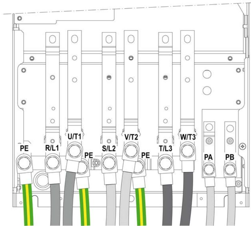
Клеммы PA/+ и PB используются для подключения тормозного резистора. См. инструкцию к тормозным резисторам [NHA87388](#) на сайте [www.schneider-electric.com](http://www.schneider-electric.com).
