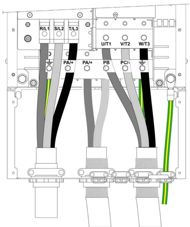
Клеммы PA/+ и PB используются для подключения тормозного резистора. См. инструкцию к тормозным резисторам [NHA87388](#) на сайте [www.schneider-electric.com](http://www.schneider-electric.com).
