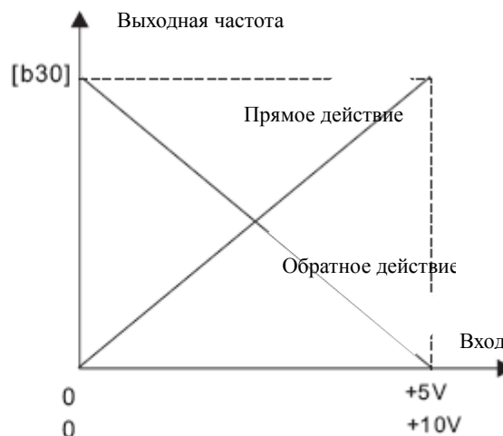
Потенциометр пульта управления 0-5 В постоянного тока Управление аналоговым напряжением 0-10 В постоянного тока
